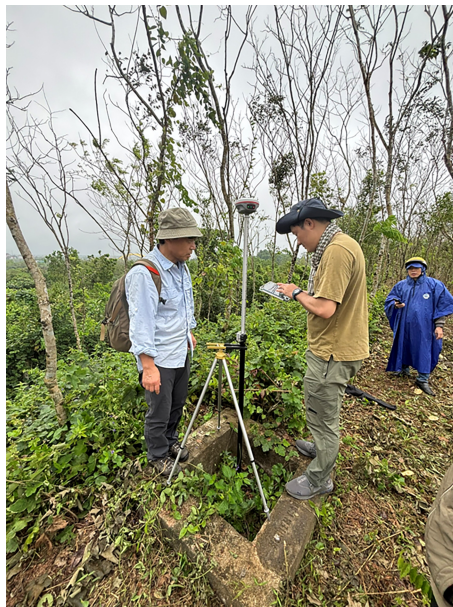
図 2. 南城壁上の基準点を GNSS で計測
