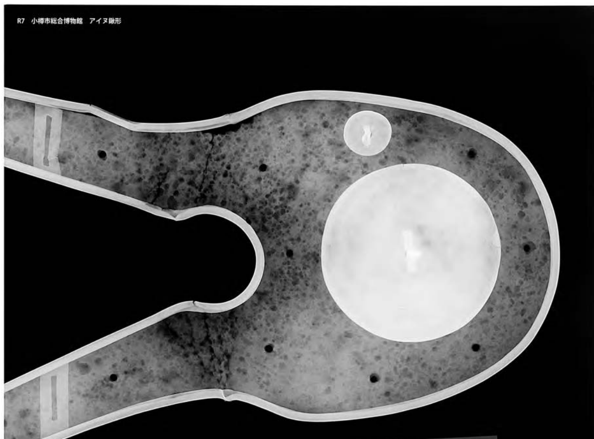
X線透過写真：中央部（撮影条件：80kV 5mA 30sec）
