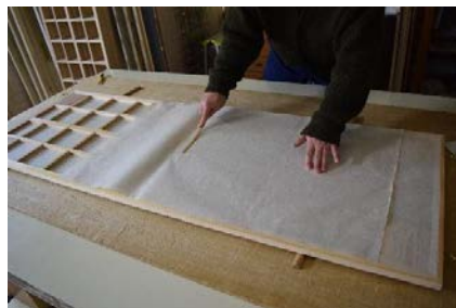
[ 下張り作業(骨縛り) ]
