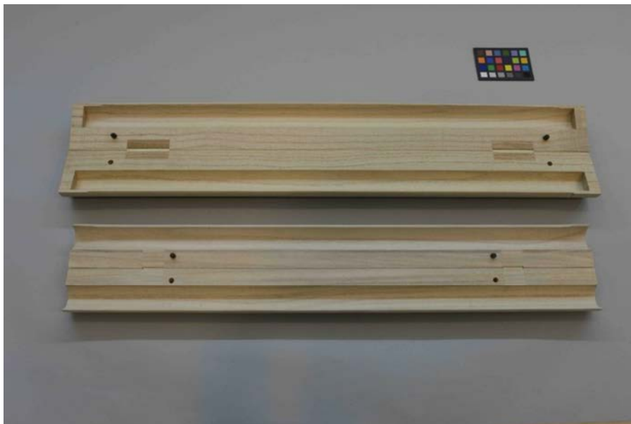
写真 37. 工程（25）、（26） 新旧の桐製太巻添軸の違い
