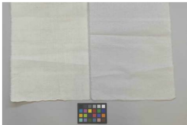
写真 25. 工程（11） 裏打紙・補修紙の準備 増裏紙①には美栖紙の厚口（左）を、 増裏紙②には美栖紙の薄口（右）を用いた。
